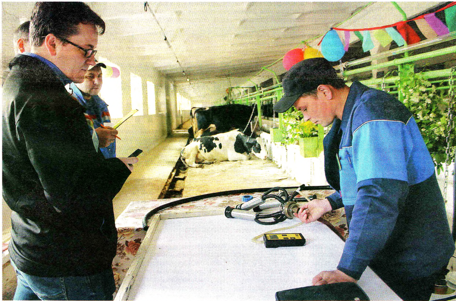
Проверку доильного аппарата с помощью мини-теста проводит Степан Колесникович
