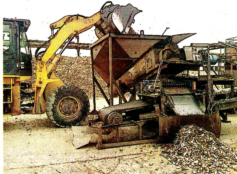
Подача щепы от переработки рейки на ленточный транспортёр
