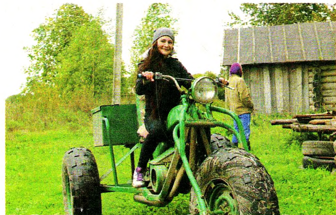
Двигатель - от мотоцикла, колёса - от тракторной тележки.
